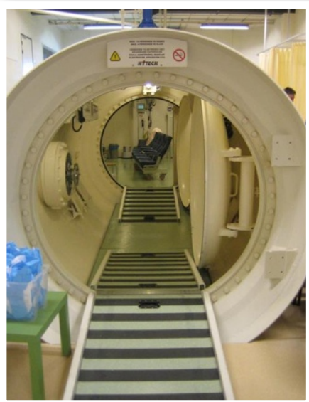
De ingang van de tank met de sluis voor de daadwerkelijke tank.
